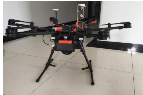
无人机激光扫描系统—麒麟云-1
